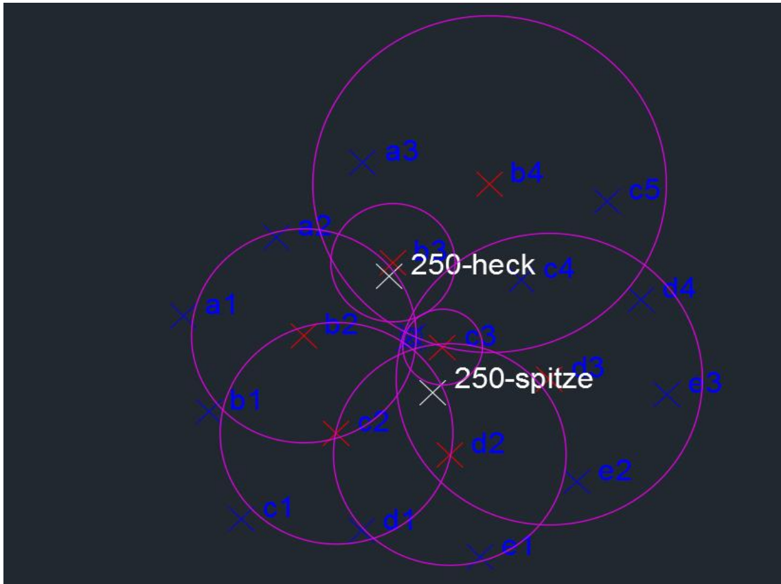
Abb. 8: Ergebnis der Triangulation für die 300 MHz Antenne, in lila sind die Abstände der detektierten Diffractions-Hyperbeln eingezeichnet, blaue Punkte zeigen die Bohrlöcher ohne Identifizierung, rote Symbole die Bohrlöcher mit einer Diffractions-Hyperbel.
