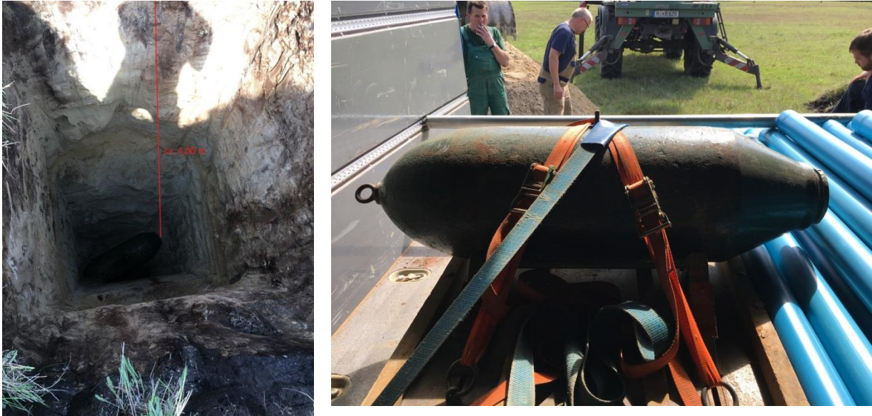
Abb. 2: (a) Testobjekt in der Grube (Tiefe ca. 4 m unter GOK); (b) Testobjekt: Fliegerbombe (500 lb)
