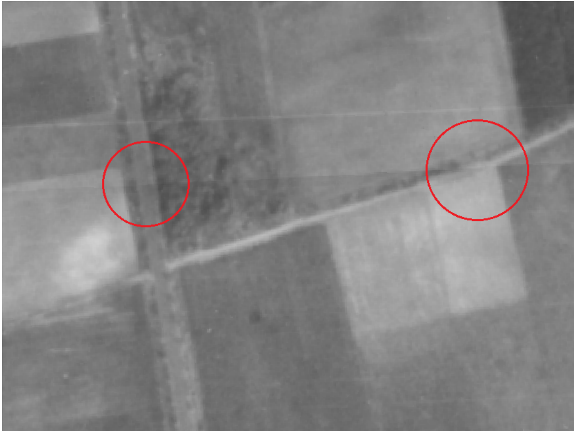
Abbildung 4.9: Bildausschnitt vom Orthophoto der Flüge 181-42-31 und 181-43-31 mit ASTER-Modell als Beispiel eines gelungenen Bildübergangs.
