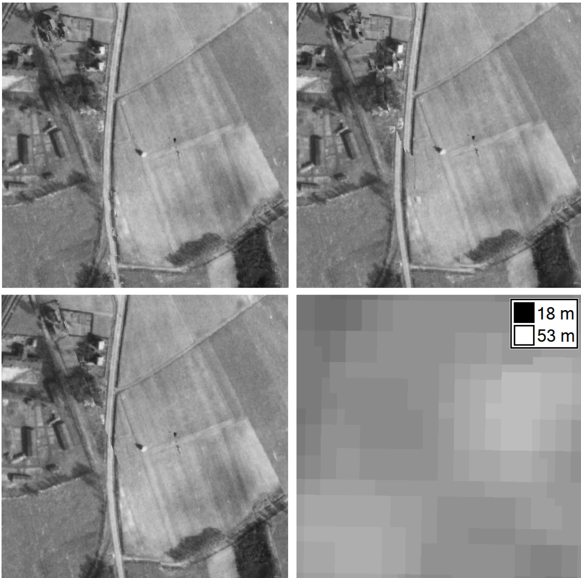
Abbildung 4.7: Gegenübergestellt wird ein Bildübergang von Flug US 33/2570. Zu sehen ist der gleiche Bildausschnitt des Orthophotos ohne externes Höhenmodell (oben links), mit ASTER-Modell (oben rechts), mit einer Ebene als Höhenmodell (unten links) und das ASTER-Modell des Bereichs als Graustufengrafik (unten rechts).
