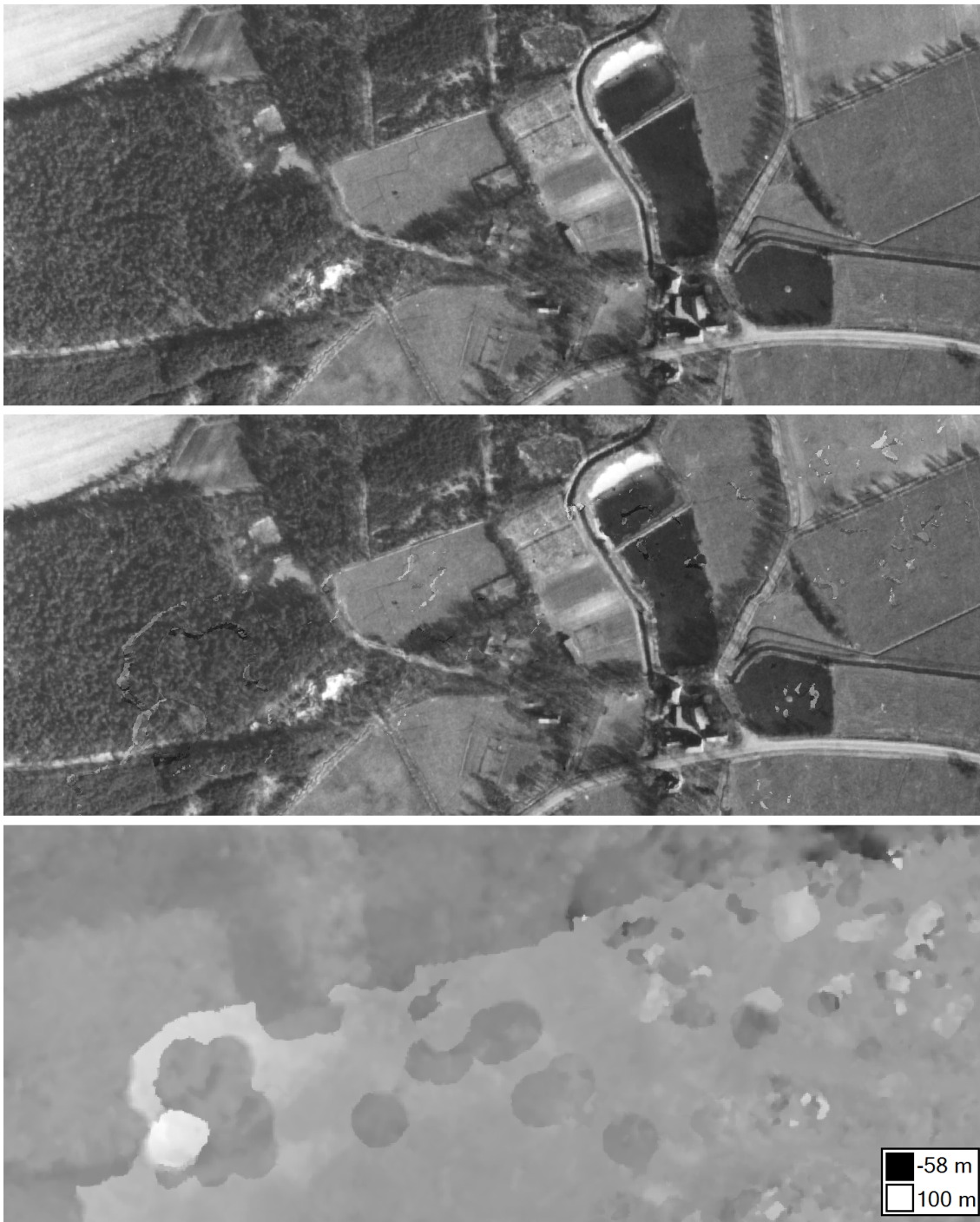
Abbildung 4.8: Vergleich von Bildausschnitten der Orthophotos des Fluges US 33/2570 mit ASTER-Modell (oben), ohne externes Höhenmodell (mittig) und des aus Bildern berechneten Höhenmodells (unten) als Graustufen.
