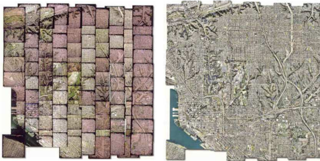
Abbildung 2.10: Aus mehreren Orthophotos zusammengesetzte Bildmosaik. Auf der linken Seite sind die Einzelbilder deutlich zu erkennen. Auf der rechten Seite wurde eine radiometrische Anpassung vorgenommen, wodurch ein homogener Gesamteindruck entsteht. [Heipke, 2013, Kapitel 3.6]
