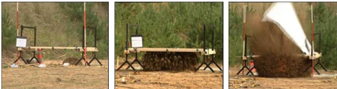
Abb. 14: Beispiel für geringen Auswurf (V01) (linkes Bild), für mittleren Auswurf (V08) (mittleres Bild) und für starken Auswurf (V10) (rechtes Bild)
