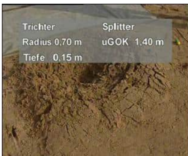
Abb. 11: entstandener Trichter V06 (linkes Bild)
