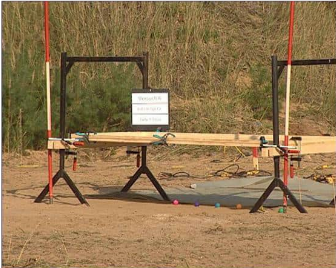
Abb. 3: Versuchsaufbau am Versuchsort mit Holzrahmen/Aluminiumblech und Folie. (Die Tischtennisbälle am Boden dienen ausschließlich der Visualisierung der Sprengauswirkungen.)
