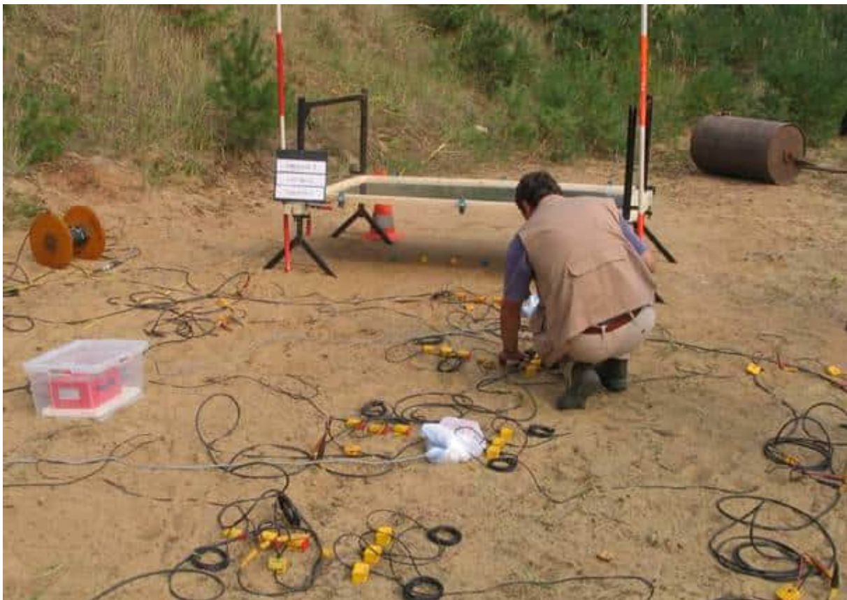
Abb. 17: Anlegen der geophysikalischen Messeinrichtungen (die gelb-roten Detektoren sind die Vertikalgeophone, die gelben die Horizontalgeophone. In der Plastiktüte befindet sich der Beschleunigungsaufnehmer, der dazugehörige Datenaufnehmer ist als roter Kasten in der Plastikbox zu erkennen.)
